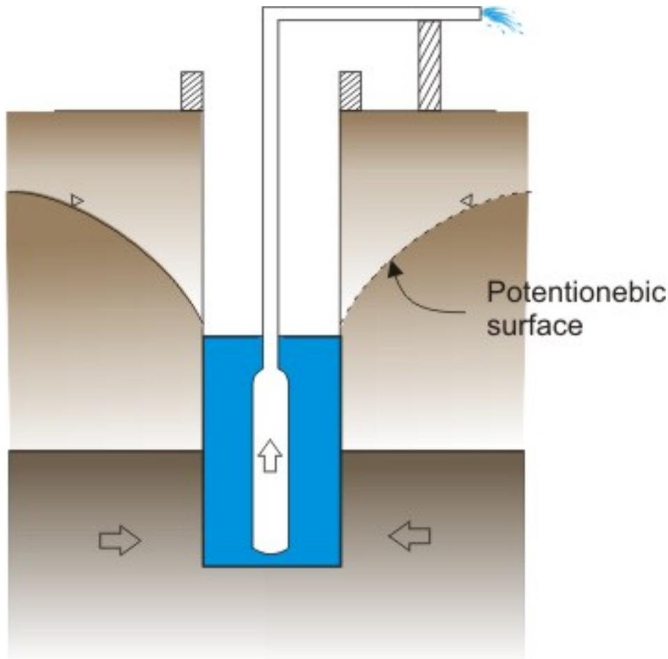
**FIGURE 5. STEADY STATE POTENTIOMETRIC SURFACE FOR CONFINED AQUIFER**
