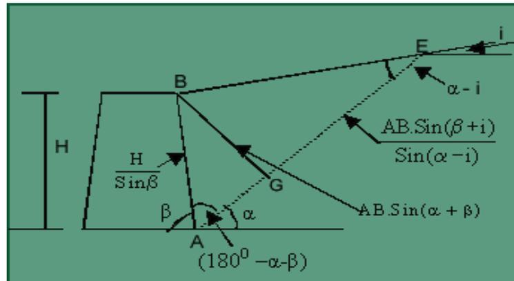
Fig. 2.13 Failure wedge
